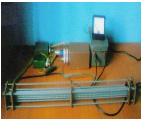
Сурет 2.7 - лас суды тазартатын электрлі тәжді озонатор
