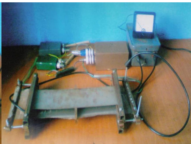
Сурет 2.7 - лас суды тазартатын электрлі тәжді озонатор
